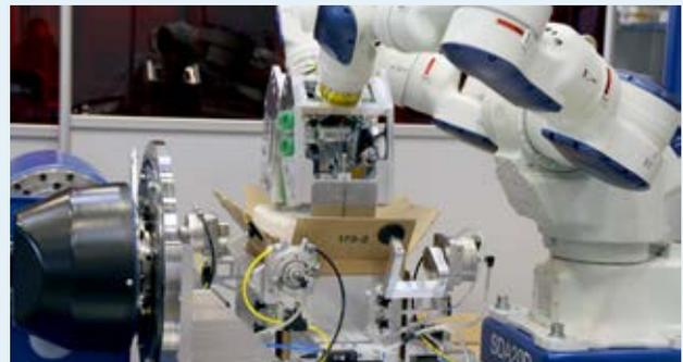
digen Anpressdruck des Greifers, der beim Zusammenpressen der Produkte im Karton erlaubt ist. Die feinfühligste Steuerung des Greifwerkzeugs, die permanent geregelte und überwachte Greifkraft sowie die exakte Platzierung des Greifers durch genaue Positionserfassung über Sensoren garantieren das produktschonende Handling. Abweichungen und kleinere Unregelmäßigkeiten bei der Anordnung der Faltschachteln im Umkarton können erkannt und vom Greifvorgang automatisch angepasst werden.
