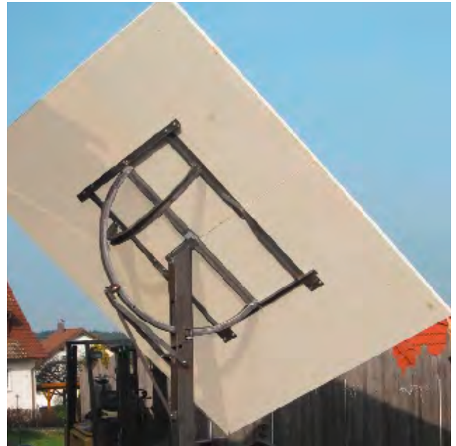
Erster Radkranz-Heliostat-Prototyp mit primärer Horizontalachse mit zunächst 8m 2 Spiegelfläche.
