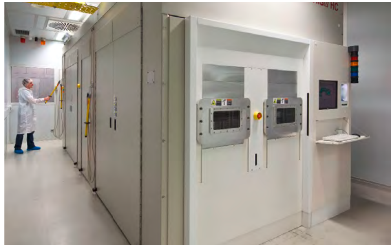
Ionenimplanter im Reinraum des Fraunhofer ISE zur Dotierung von Silicium mit Bor und Phosphor mit einer sehr exakten lokalen Auflösung.
