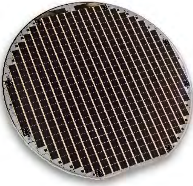
Zellen für konzentrierende Photovoltaik auf einem Wafer bzw. vor der Vereinzelung.
