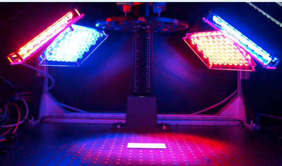
Untersuchung des Langzeitverhaltens von CIS-Dünnschicht-solarzellen mittels Temperatur-, Beleuchtungs- und elektrischen Belastungstests
