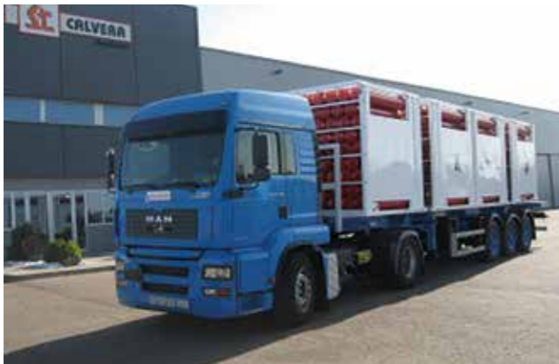
Abbildung 16: LKW mit Trailerauflieger für Wasserstofftransport in Typ-3-Kompositbehältern bei 50 MPa (Quelle: Calvera 2012).
