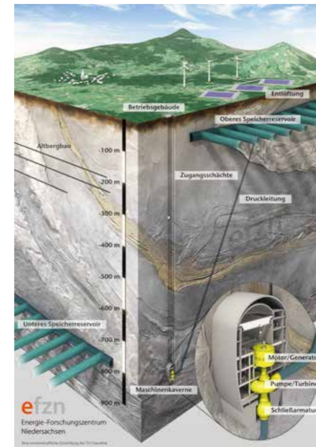
Abbildung 4: Der prinzipielle Aufbau eines PSW unter Tage (Grafik: Energie-Forschungszentrum Niedersachsen der TU Clausthal efn)
