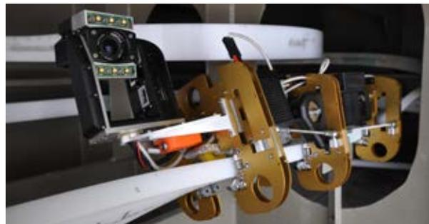
Abbildung 3: Prototyp des Ballastwassertank-Inspektionsroboters während der Tests im Ballastwassertank
