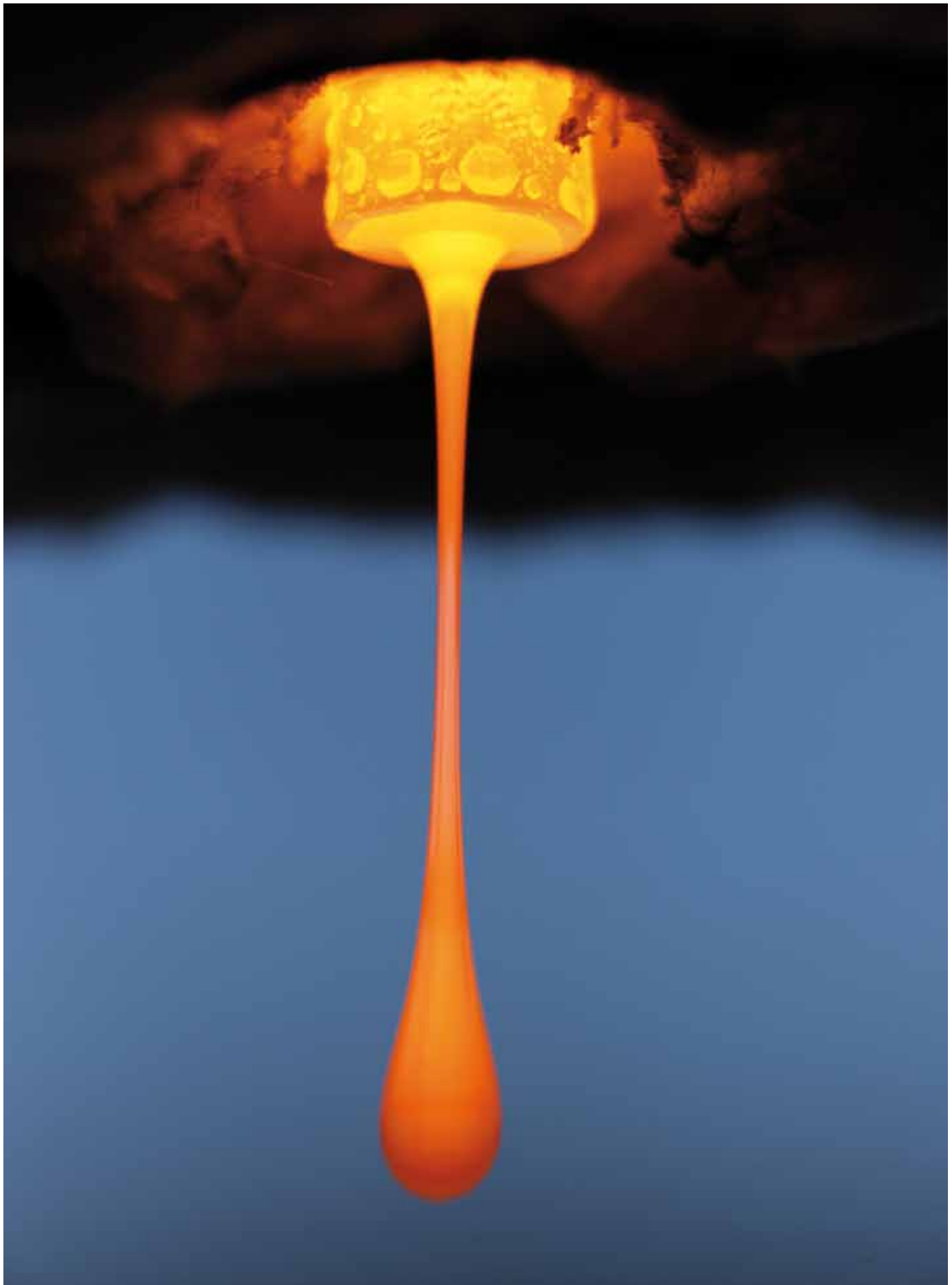
Ein Glaspfen beim Austritt aus einem rund 1500 Grad heißen Jülicher Induktionsschmelzofen. © Forschungszentrum Jülich.
