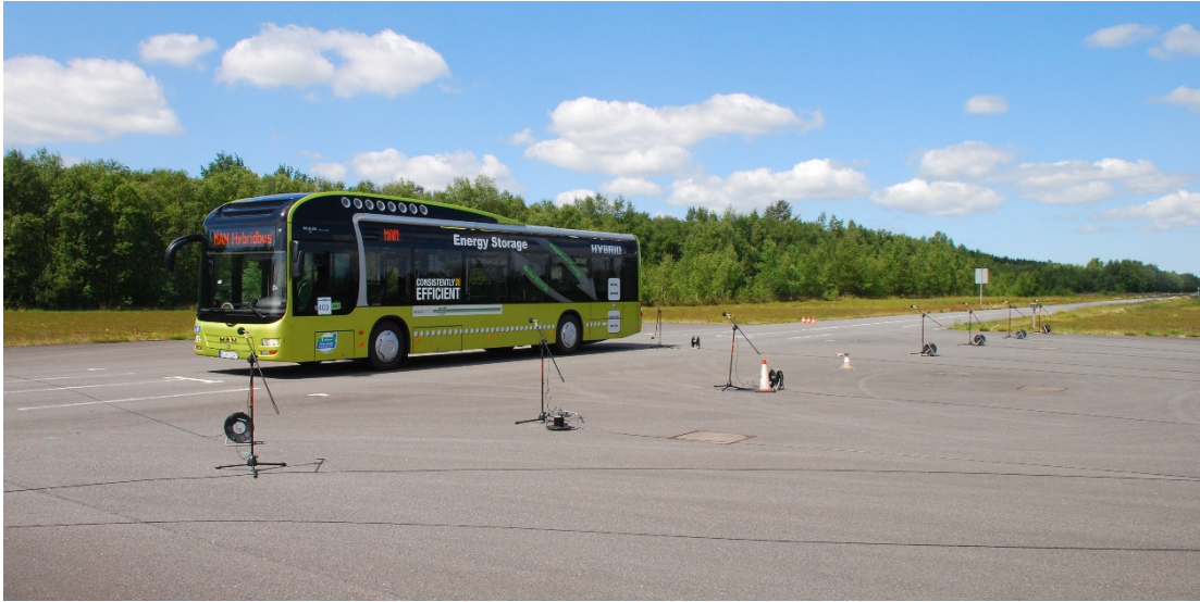
Abbildung 19: ISO-Geräuschmessstrecke der ATP in Papenburg
